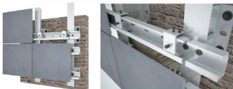
شکل ۷-۱۲- سیستم نصب پنهان با ایجاد مهار در پشت سرامیک
