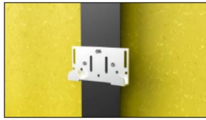
۲- نصب کلیپس‌های تحتانی بر روی پروفیل‌های قائم
