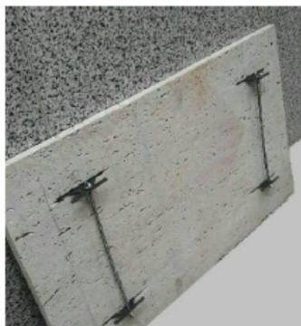
شکل ۴-۱- مهاری سنگ با استفاده از ایجاد شکاف مورب و تعبیه صفحات فولاد گالوانیزه،
