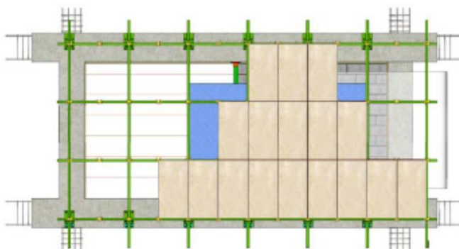
شکل ۴-۱۳- جزئیات اجرای نمای پرده‌ای سنگی
