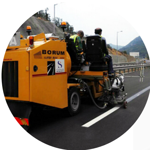
خط کشی و اجرای مکانیزه و دستی
